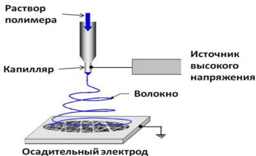
Рисунок 14 - Схема получения нановолокон полимеров методом капиллярного электроформования [52]
