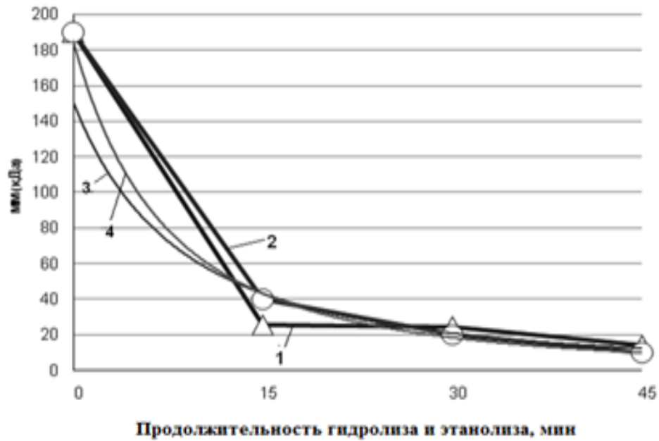
Рисунок 30 - Кинетические кривые деструкции хитозана в условиях гидролиза (1) и этанолиза (2) и их аналоги, аппроксимированные по уравнениям: для гидролиза y = 15225x^{-1,77} , R^2 = 0,909 (3) и этанолиза y = 18197x^{-2,04} , R^2 = 0,997 (4)
