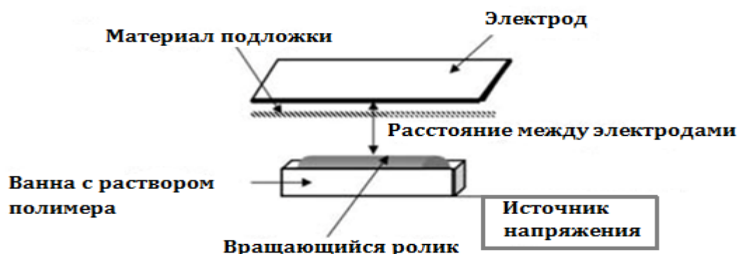
Рисунок 15 - Схема формовочной камеры Nanospider [54]
